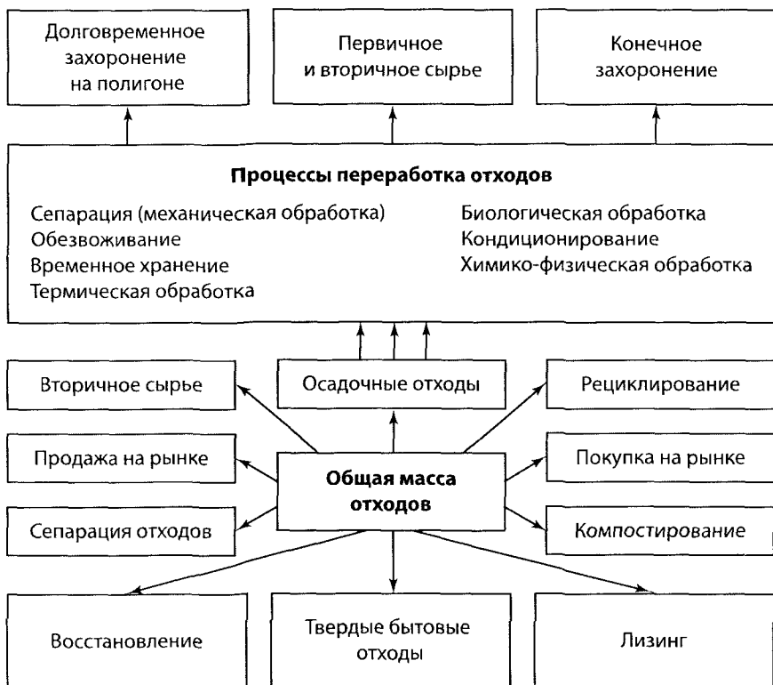
Рис. 5.10. Схема концепции интегральной переработки твердых отходов
