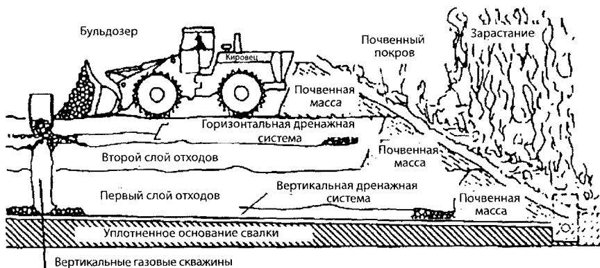
Рис. 5.7. Схема устройства и функционирования полигона
